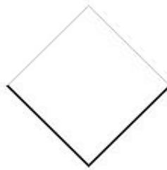
Der  $45^\circ$ -Winkel ist optimal. Fügt man zwei solche Rinnen zu einem Rohr zusammen, dann hat dieses den optimalen (=quadratischen) *Rhombenquerschnitt*. So sieht man nun auch, weshalb sich für  $n=2$  die optimale rechteckige Rinnenform ergibt. Ergänzt man diese Form in analoger Weise, erhält man das Quadrat als optimalen *Rechteckquerschnitt*:
